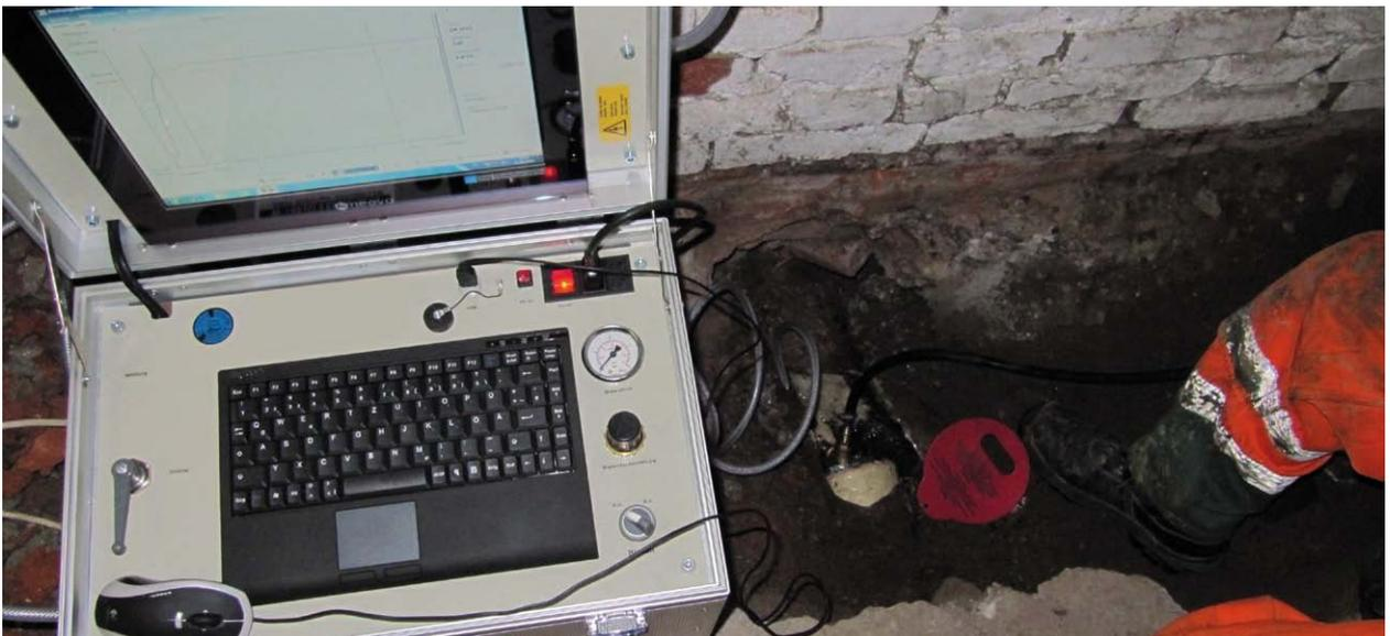
Druckverlustmessung bei der Dichtheitsprüfung mit Luftdruck
