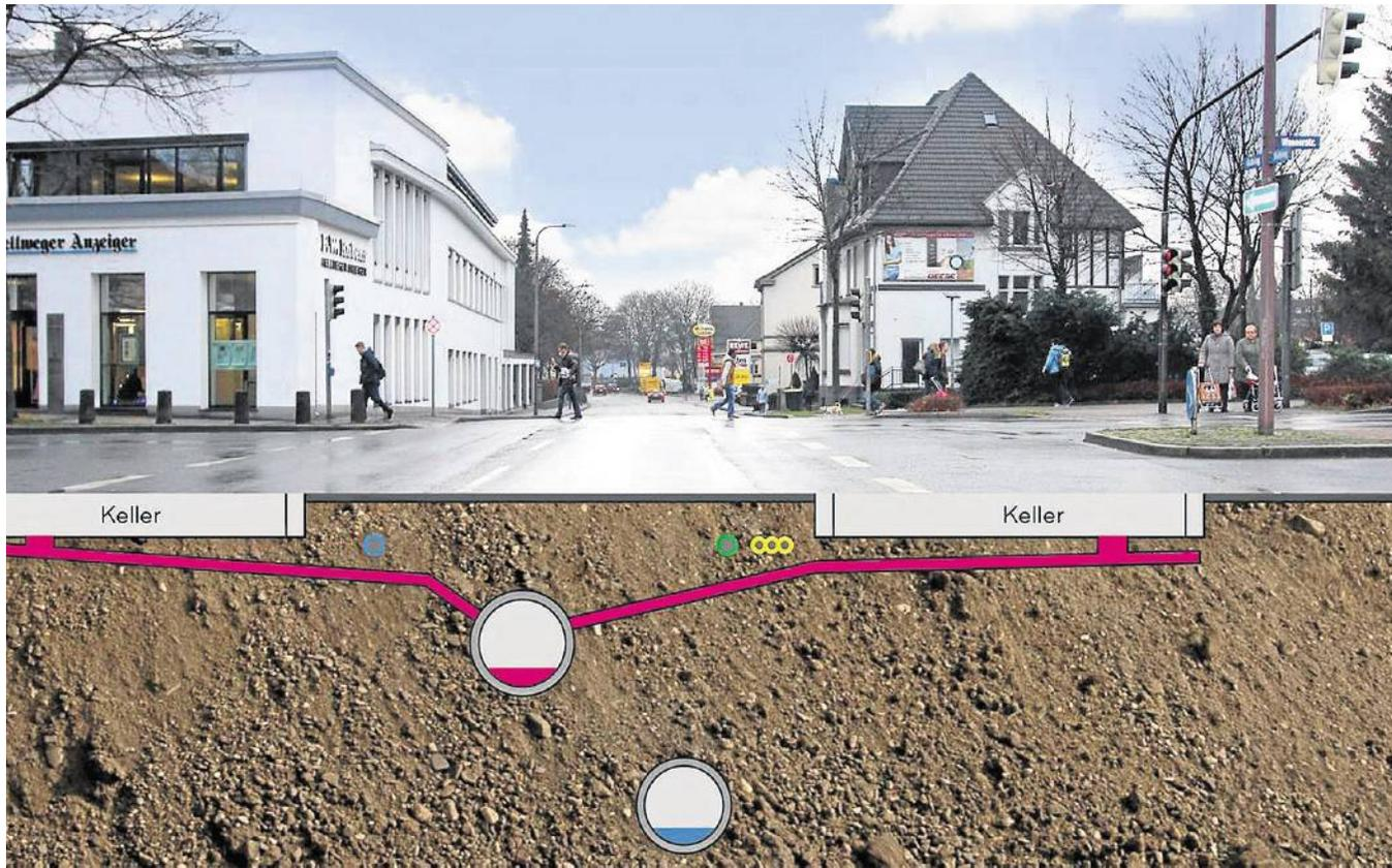
Dieser schematische Querschnitt der Stadtbetriebe zeigt am Beispiel des Ostrings, was es im Boden unter Unna zu finden gibt. Etwas unter der Unterkante der Keller liegen Trinkwasser-, Strom-, Gas- und Telekommunikationsleitungen. Noch tiefer liegt der Kortelbach, in den per Gefälle Abwässer einlaufen. Der neue Frischwasserkanal wird mit sicherem Abstand unter diesem Geflecht gebaut.
